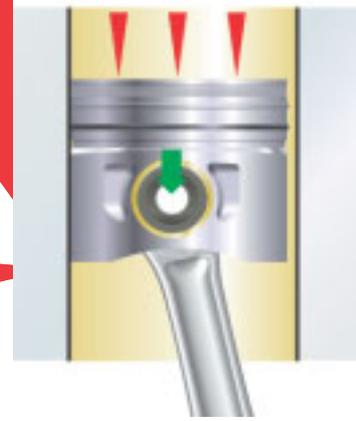
Im Bereich des oberen Totpunktes wechselt die Kolbenseitenkraft die Richtung. Dort wird der Kolben auf die gegenüberliegende Zylinderwand gekippt und verursacht dadurch Geräusche. Um dies zu verringern, ist die Pleuelstange außermittig angeordnet.
